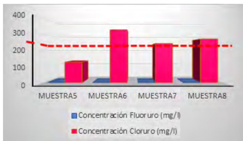
Figura 1. Concentración de fluoruros y cloruros en muestras de agua de pozo.
